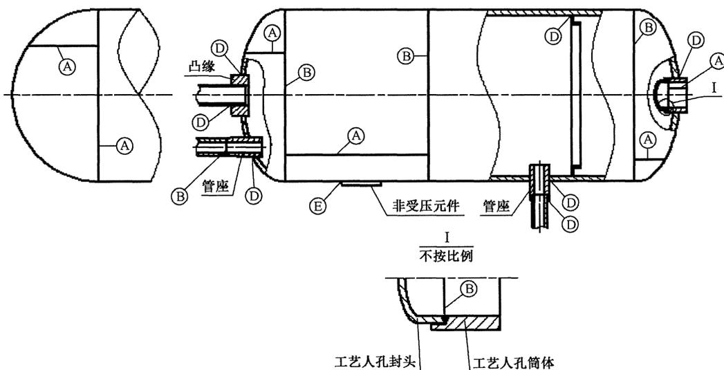
图 1 内容器焊接接头分类
